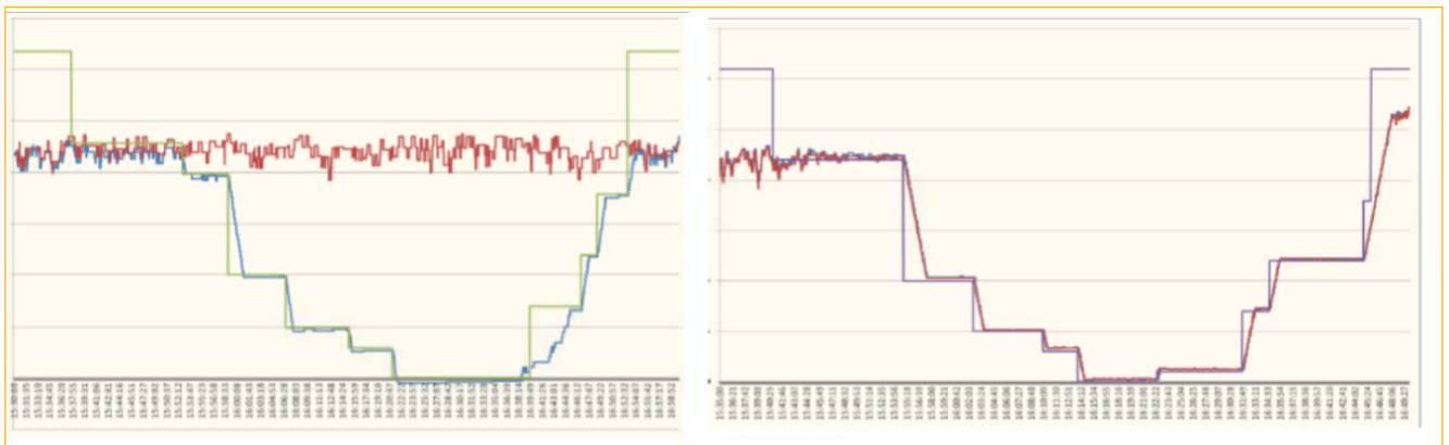
Ilustración 17: Resultados de una prueba de puesta en servicio de una central eólica irlandesa, que muestra la señal de consigna (verde), la potencia de salida (azul) y la potencia de salida teóricamente disponible transmitida por la central al operador. La prueba de la izquierda se ha superado positivamente, mientras que la de la derecha no, ya que la señal de energía disponible sigue a la potencia de salida de energía. [11]
