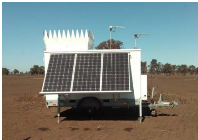
Figura 47. Ejemplo de SODAR (Fuente: Barlovento)
